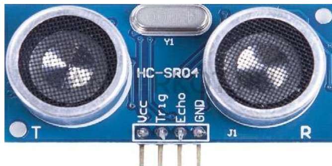
Рис. 16. Ультразвуковой датчик (дальномер)
